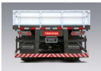
A nova traseira conta com lanternas em LED recuadas, para-choque articulado e suporte de placa.
