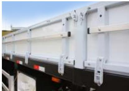
Guardas com estrutura metálica e revestimento em ACM tornam o produto mais leve, resistente e longevo.
