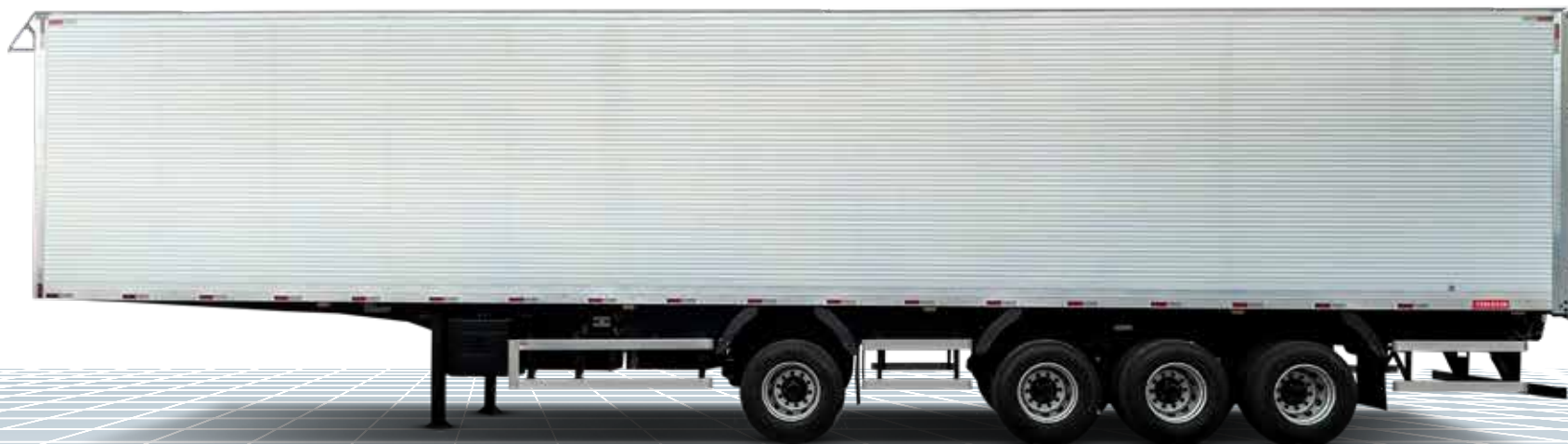
Na versão 4 eixos, o primeiro eixo é distanciado, possui suspensão pneumática e sistema direcional (manga de eixo), os demais eixos possuem suspensão mecânica Autolub não necessita de lubrificação, resistente leve e de fácil manutenção.
