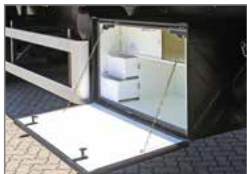
Caixa rancho com acabamento interno em fórmica, equipada com gavetas e borrachas de vedação.
