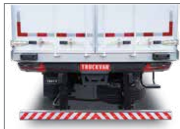
Nova traseira, mais moderna, robusta e com o quadro traseiro parafusado no chassi e na caixa de carga, integrando o novo modelo de porta, com melhor acabamento, travamento e vedação.
