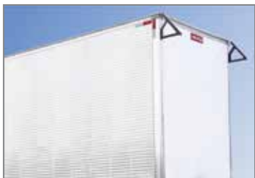
Frontal equipado com livra fio. Novo modelo de teto, proporciona melhor vedação
