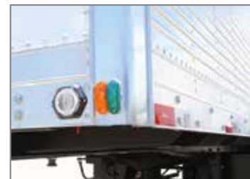
Caixa de carga com novos perfis de alumínio, proporcionando leveza e robustez ao produto.
